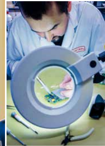
> Réparation de composants électroniques miniatures
